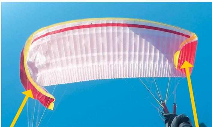
Standard Unterschneiderklapper am rechten Flügel
