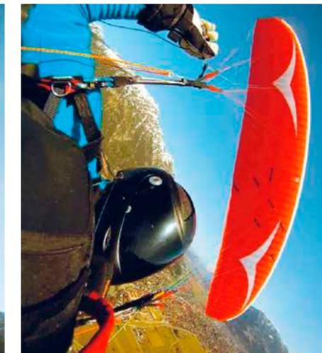
Testflug: Nur durch konsequentes Anbremsen des Außenflügels (rechte Steuerleine), gelingt es dem Testpiloten den Schirm aus der stabilen Sturzspirale herauszuholen und über einen steilen Kurvenflug in den Normalflug überzugehen.
