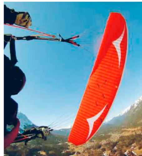
Testflug: Deutlich sichtbar geht der Gleitschirm auf die Nase und nimmt sehr hohe Sinkwerte auf. In diesem Fall zeigt das Gerät nach Freigeben der Innenbremse die Tendenz in die stabile Spirale zu beschleunigen.
