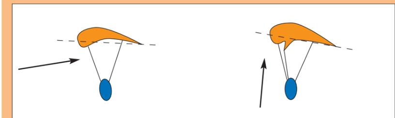
Abb.6: Schirm im Normalflug. Der Anstellwinkel ist definiert als der Winkel zwischen Profilsehne (gestrichelte Linie) und der Anströmrichtung (Pfeil). Beim Vornicken der Kappe wird der negative Anstellwinkel (zu kleiner Anstellwinkel = Einklapper) relativ bald erreicht.
