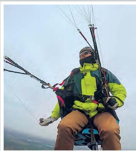
**Abfangen:** Ein etabliertes Kommando bei Sicherheitstrainern. Dabei wird die Vorschiebbewegung der Kappe gestoppt. Entscheidend ist die Zuggeschwindigkeit. Die Steuerleinen werden schnell und >
