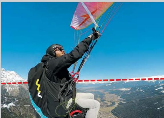
Die Kappe ist vor dem Piloten und der Pilot ist gerade wieder am Darunterpendeln (wie oben in der Grafik dargestellt). Gefühlt ist alles ok. Die Kappe ist vor dem Piloten und der Fahrtwind fühlt sich normal an. Blickt man jedoch auf den Windspion, ist der Anstellwinkel in diesem Moment sehr hoch. Steuerausschläge können jetzt schnell zum Strömungsabriss führen. Die Steuergriffe müssen erstmal oben bleiben.
