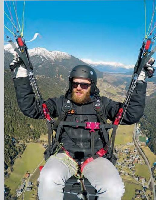
Mit der richtigen Gurtzeugeinstellung führt man die Hände bei der Steuerung immer an den Tragegurten entlang. Die Steuerung erfolgt von Führungsrolle in Richtung Karabiner.
