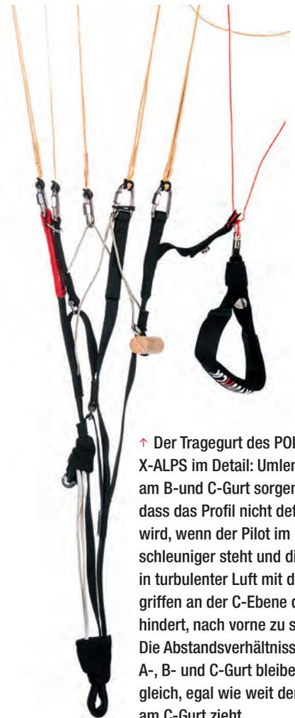
↑ Der Tragegurt des POISON X-ALPS im Detail: Umlenkungen am B- und C-Gurt sorgen dafür, dass das Profil nicht deformiert wird, wenn der Pilot im Fußbeschleuniger steht und die Kappe in turbulenter Luft mit den Holzgriffen an der C-Ebene daran hindert, nach vorne zu schießen. Die Abstandsverhältnisse zwischen A-, B- und C-Gurt bleiben immer gleich, egal wie weit der Pilot am C-Gurt zieht.
