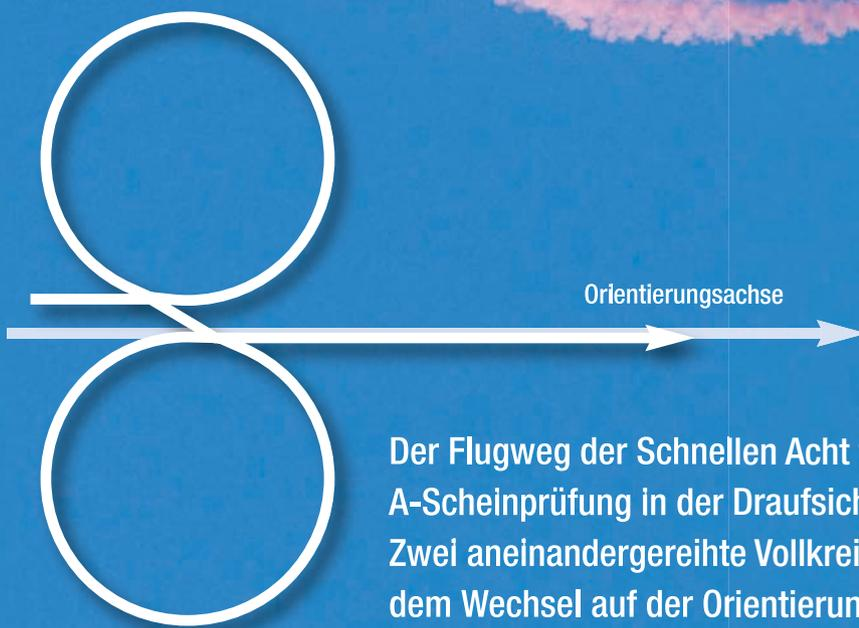
Der Flugweg der Schnellen Acht für die A-Scheinprüfung in der Draufsicht. Zwei aneinandergereihte Vollkreise mit dem Wechsel auf der Orientierungsachse.
