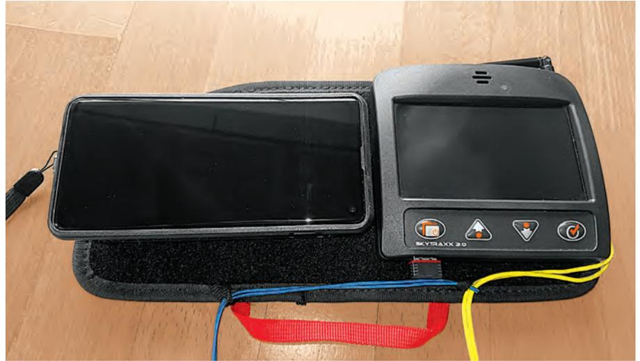
↑ Cockpit-Aufbau mit SKS Compit+ (Samsung S10 in Systemhülle) und FLARM-Vario
