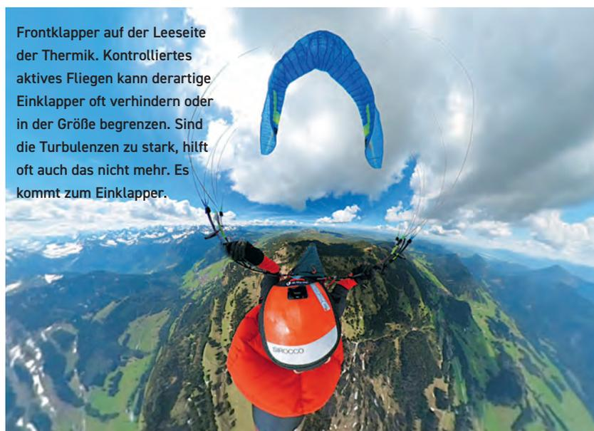
Frontklapper auf der Leeseite der Thermik. Kontrolliertes aktives Fliegen kann derartige Einklapper oft verhindern oder in der Größe begrenzen. Sind die Turbulenzen zu stark, hilft oft auch das nicht mehr. Es kommt zum Einklapper.
