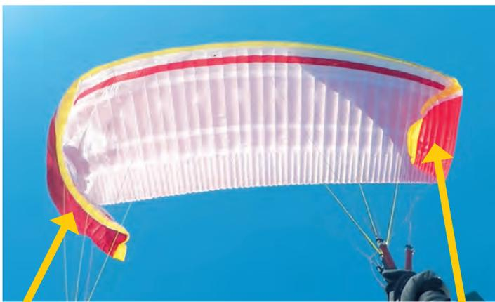
Standard Unterschneiderklapper am rechten Flügel
