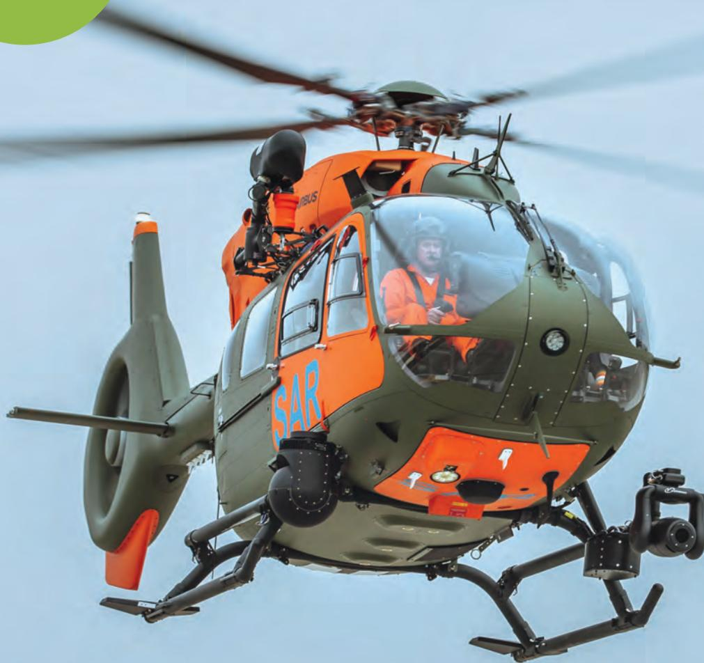
Leistungsfähiger voll nachflugtauglicher Airbus H145 des SAR-Kommandos Niederstetten (u.a. für den süddeutschen Raum verantwortlich), der für den Rettungseinsatz großzügig bestückt ist. Angebaut ELT-/PLB-Peiler: im Anflug können PLBs (oder ELTs) im sog. Homing-Verfahren bereits aus mehreren Kilometern Entfernung auf 121,5 MHz (Flugnotfall-Frequenz) richtungsmäßig angepeilt werden.
