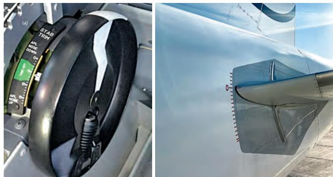
↑ Die Trimmung beim Flugzeug wird über das Trimmerknopf bedient und verstellt die Höhenflosse, um einen gewünschten Anstellwinkel einzustellen ohne die Steuerruder auszulenken.
