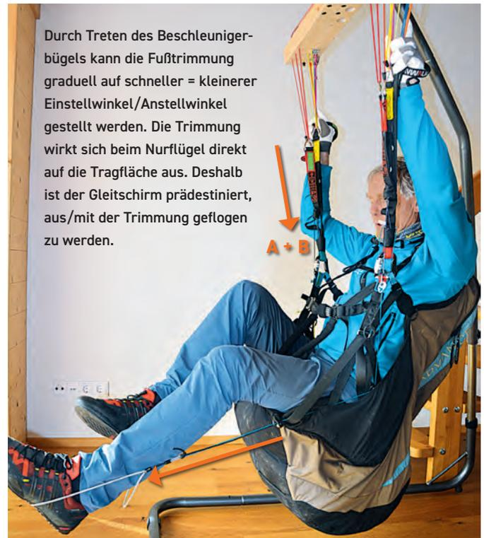
Durch Treten des Beschleunigerbügels kann die Fußtrimmung graduell auf schneller = kleinerer Einstellwinkel/Anstellwinkel gestellt werden. Die Trimmung wirkt sich beim Nurflügel direkt auf die Tragfläche aus. Deshalb ist der Gleitschirm prädestiniert, aus/mit der Trimmung geflogen zu werden.
