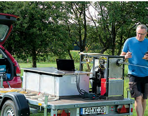
↑ Windenanhänger mit einem Windenmodul und Akku
