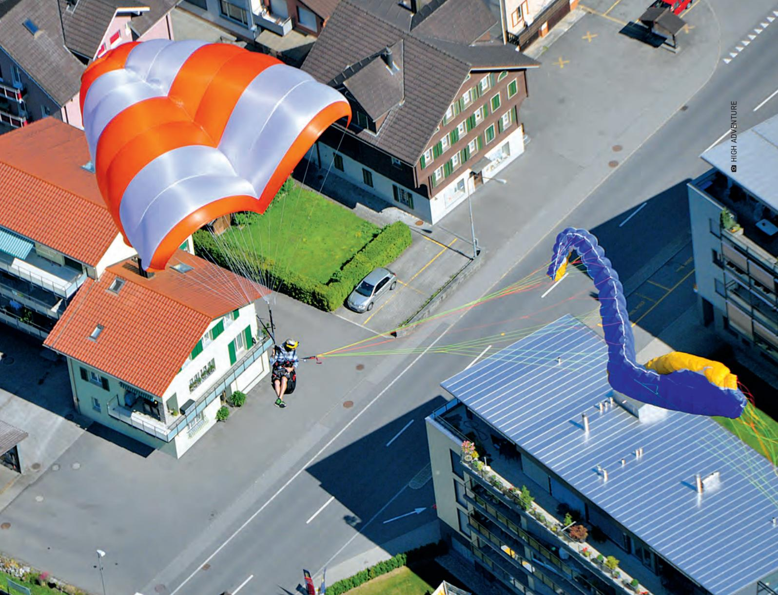
des wieder geöffneten Hauptschirm in entgegengesetzte Richtungen nach unten und es kommt bei relativ hoher Sinkgeschwindigkeit zu einem fast stabilen Flugzustand. Tom Grabner sagt, dass es bei der Diamond Cross konstruktiv (sie hat einen S-Schlag im Profil) nicht zum „down plane“ kommen könne. Er weiß aber auch, dass es auch bei unlenkbaren Rettern immer wieder mal zum „down plane“ kommen kann.
