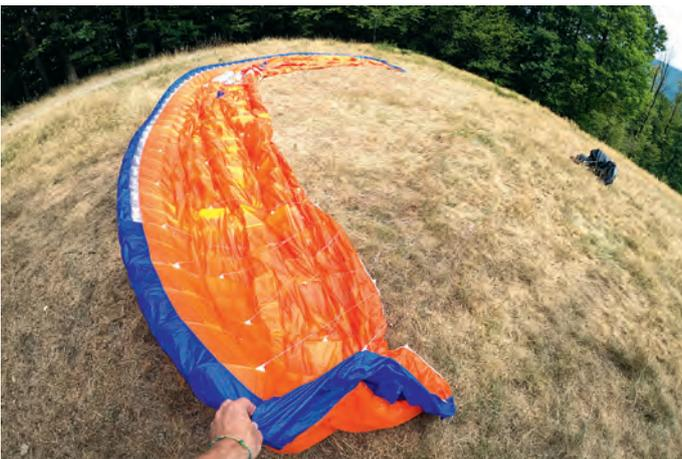
9| Nur bei Nullwind und ohne Helfer: Um die Kappe ganz sauber im Bogen auszulegen, kann man das Gurtzeug mit gestreckten Leinen vor dem Schirm ablegen und als Anker nutzen. Erst dann wird die Kappe gegen den Leinenwiderstand abschnittsweise weiter geöffnet und mit vorgespannter Eintrittskante abgelegt.
