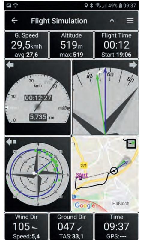
Die neueste Version der kostenlosen und werbefreien Android App Gleitschirm-Cockpit speichert jetzt signierte IGC-Files. Außerdem ist durch die Nutzung des Näherungssensors die App auch mit Handschuhen bedienbar. Nach dem Flug gibt das Flugbuch Auskunft über die gespeicherten Flüge und bietet eine Monats-Statistik über Fluganzahl und Dauer in Form eines Balkendiagramms an.
