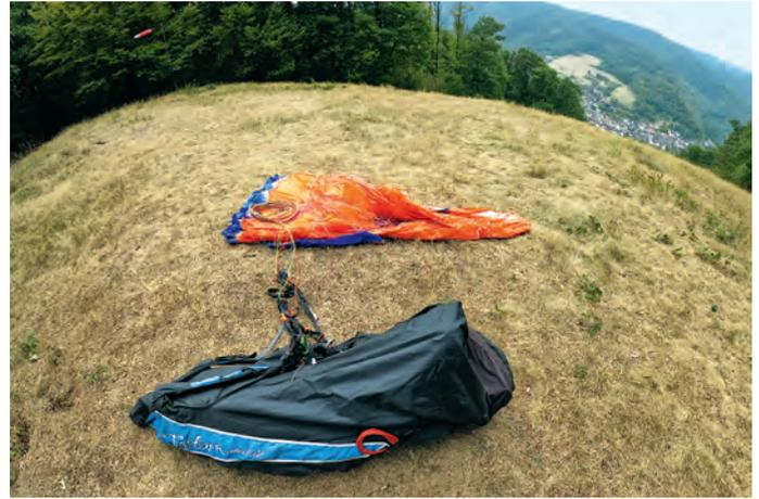
2| Der Schirm wird anfangs nur leicht geöffnet. So wird das Leinenbündel sichtbar und kann direkt gegriffen werden. Die gebündelten Stammleinen sind im Grunde schon so gut wie fertig sortiert.
