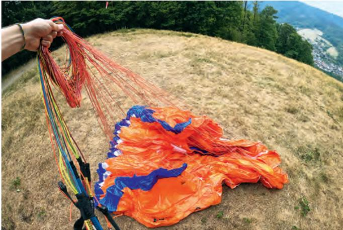
3| Hebt man das Bündel in der Hand, strecken sich automatisch die Galerieleinen und man kann sie aus der Nähe sehr gut kontrollieren. Hängt alles frei, ist kein weiteres Vorsortieren mehr nötig.
