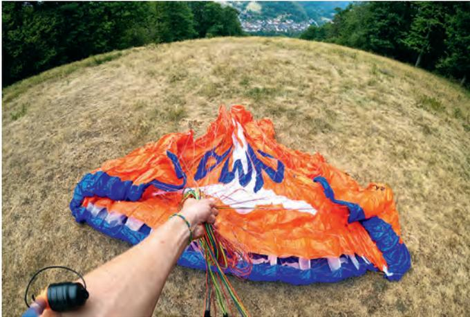
4| Vor dem Start wird der Schirm als Tulpe am Startplatz abgelegt und aus der Mitte heraus etwas geöffnet. Das Leinenbündel bleibt die ganze Zeit in der Hand des Piloten!
