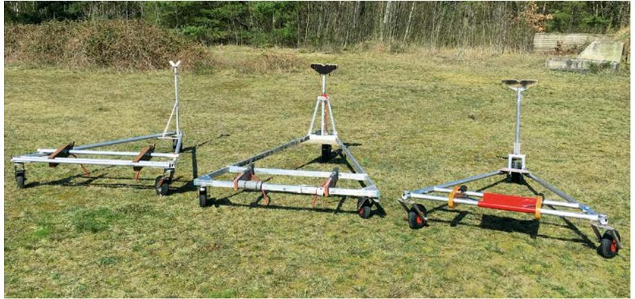
↑ Von links: Eigenbau aus Drachenrohren, stabiler Eigenbau aus Vierkantprofilen, professioneller Startwagen
