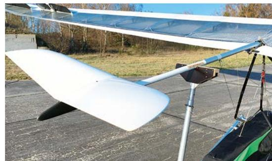
↑ Kielrohrauflage mit flachem Holzaufsatz
