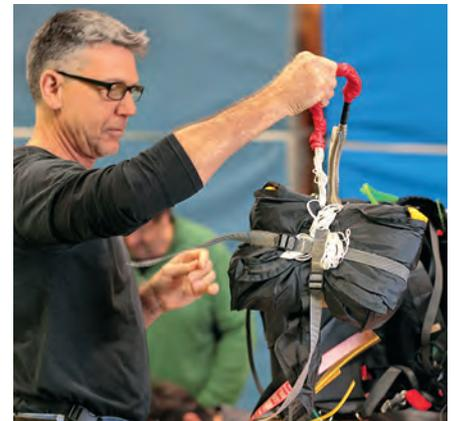
→ Die Innencontainer werden ausgebaut und mit einem speziellen Packband überkreuz verschnürt, so dass sich der Innencontainer nicht öffnet. Ein mehrmaliges Werfen ist somit möglich.
