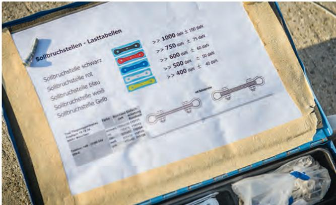
↑ Der Vorratskoffer mit den Sollbruchstellen. Farblich sauber nach Auslösekraft sortiert. Werden dann einzeln oder kombiniert in die Führung eingehängt.
