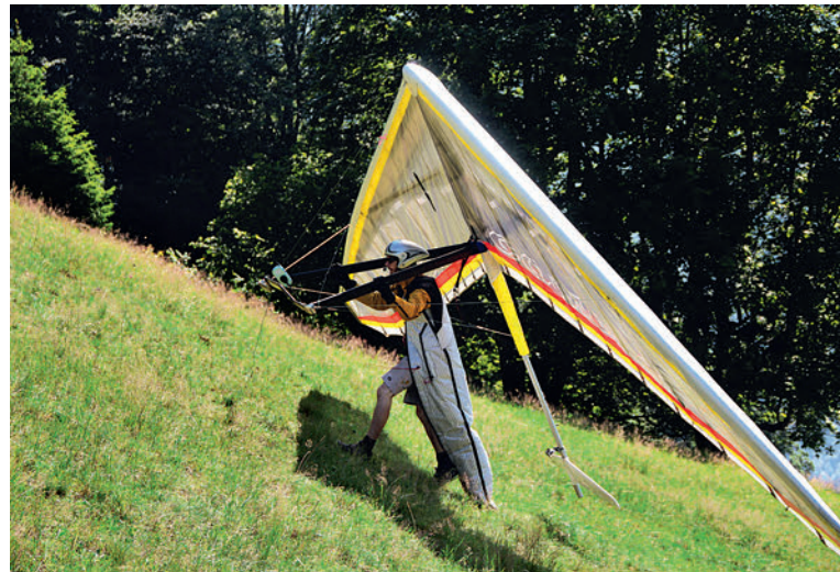
↑ Die Arme werden gebeugt und das Gerät wird kontrolliert aufgenommen.
