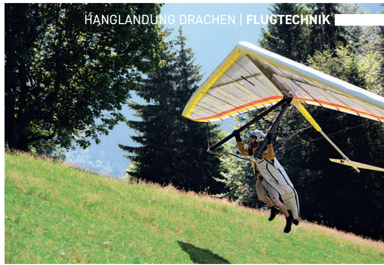
↑ Erst wenn die Unterarme annähernd senkrecht sind, ist die Geschwindigkeit für ein folgendes dynamisches Ausstoßen erfolgt.
