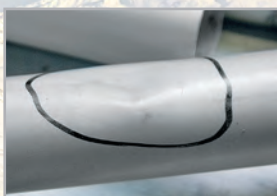
Eine Beule am Flügelrohr lässt sich im eingebauten Zustand nur schwer erfühlen, wenn sie hinter der Mylar-Anströmkannte liegt.
