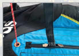
Die Hauptaufhängung muss auf Scheuerstellen untersucht werden.
