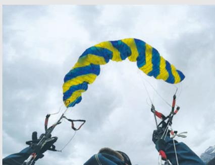
Unbeschleunigte Frontklapper öffneten stets selbstständig.
