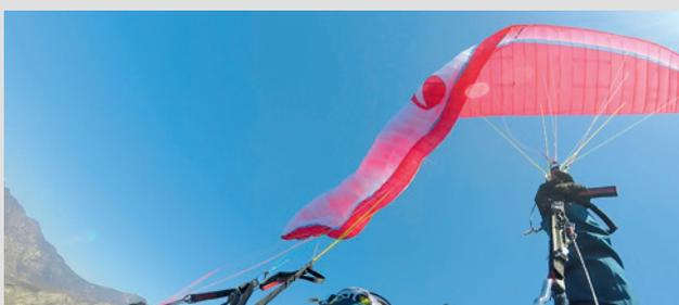
Seitlicher Einklapper unbeschleunigt
