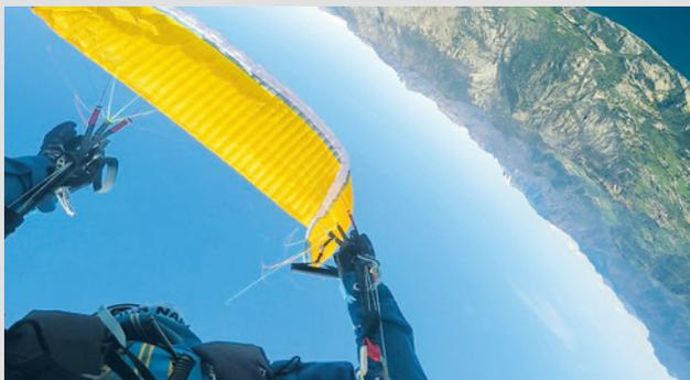
Gegenklapper nach seitlichem Einklappen mit Verhängertendenz
