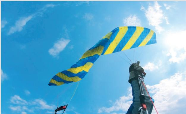
Seitlicher Einklapper unbeschleunigt
