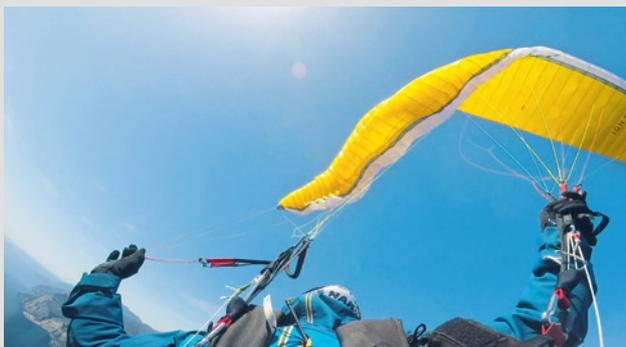
Seitlicher Einklapper unbeschleunigt
