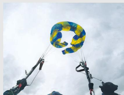
Frontklapper vollbeschleunigt mit 100 % Einklapptiefe. Bei 95 kg Startgewicht blieb der Frontklapper stabil und musste aktiv vom Piloten geöffnet werden. Bei 105 kg Startgewicht öffnete der Schirm stets selbstständig.
