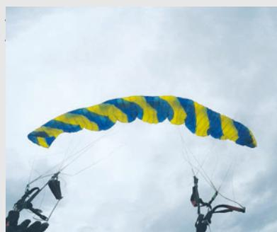
Vollbeschleunigte Frontklapper mit 50 % Einklapptiefe öffneten stets selbstständig
