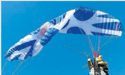
Maximal großer unbeschleunigter seitlicher Einklapper. Die Öffnung erfolgte zu Beginn langsam Zelle für Zelle. Das letzte Drittel öffnete zügig.
