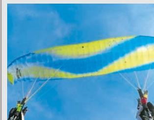
Nachsacken: Auch wenn der Schirm komplett geöffnet war, konnte er noch etwas im Sackflug verweilen. Zu sehen am faltigen Untersegel. Hier hieß es, Hände bei den Führungsrollen lassen, bis der Schirm angefahren ist.
