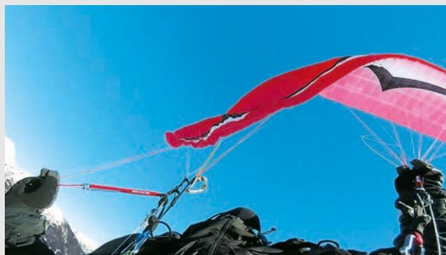
Gutmütig, selbst bei maximal großen Einklappern. Unbeschleunigt ließ der Sprint 3 dem Piloten viel Zeit zum Reagieren. Das Vornicken und Wegdrehen erfolgte langsam. Dafür nickte er weit nach vorne.
