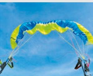
Maximale Einklapptiefe im unbeschleunigten Flug. Der Schirm öffnete schnell.
