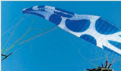
Markante Knicklinie im Bereich des Spannbandes. Die Hinterkante blieb lange gefüllt und entschärfte die Reaktionen auf Einklapper.
