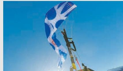
Maximal großer beschleunigter seitlicher Einklapper. Der Schirm nickte etwas dynamischer vor als unbeschleunigt.
