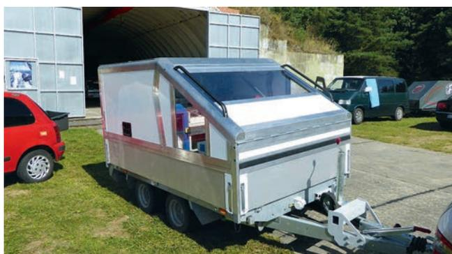
↑ Im Einsatz als Wetterschutz des Windenfahrers konzipiert, beim Transport der Schutz der Winde. Die Multiwinde ausgetüftelt bis ins Detail.
