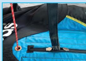
Die Hauptaufhängung muss auf Scheuerstellen untersucht werden.
