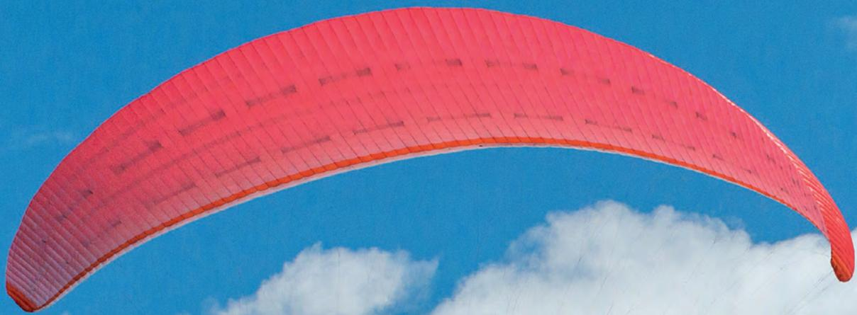
Der Nova Phantom besitzt 99 Zellen – bei gleicher Streckung wie ein Ion 4, der nur 49 Zellen aufweist.
