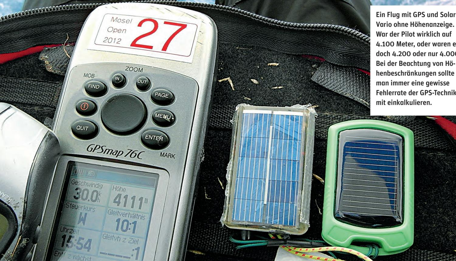
Ein Flug mit GPS und SolarVario ohne Höhenanzeige. War der Pilot wirklich auf 4.100 Meter, oder waren es doch 4.200 oder nur 4.000. Bei der Beachtung von Höhenbeschränkungen sollte man immer eine gewisse Fehlerrate der GPS-Technik mit einkalkulieren.
