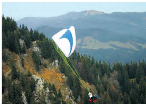
**BILD 6** | So stark kann es Gleitschirme beim Einfliegen in die Thermik aufstellen. Anschließend überlegen, ob man in diese Thermik möchte oder lieber woanders hinfliegt.
