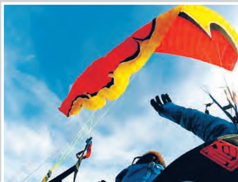
U-Turn Emotion 3: Nur mit zwei Händen und maximaler Kraft (Bild links) waren flächentiefe Klapper mit steiler Knicklinie (Bilder Mitte und rechts) möglich. Dennoch waren die Schirmreaktionen gutmütig.
