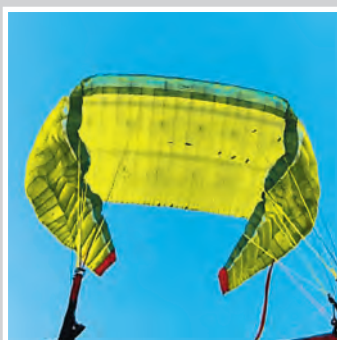
Problemloses Ohrenanlegen bei Emotion 3, Infinity 4 und Iota.
