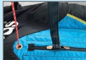
Die Hauptaufhängung muss auf Scheuerstellen untersucht werden.
