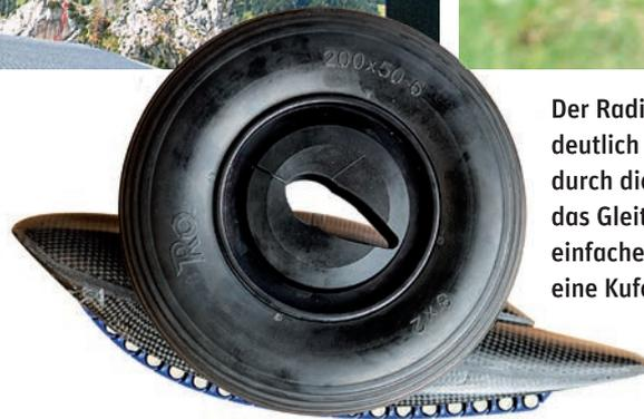
Der Radius ist bei einer Kufe deutlich größer als bei Rad, durch die elliptische Form wird das Gleiten auf dem Boden einfacher. Oben deutlich eine Kufe mit Ketten.
