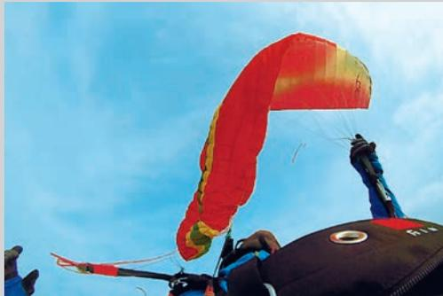
**BGD Adam M:** Die seitlichen Einklapper haben im vollbeschleunigten Zustand (Bild rechts) eine deutlich steilere Knicklinie – das Verhalten wurde nur geringfügig dynamischer. Erstaunlich: Die maximale Sinkgeschwindigkeit hat die 9 m/s nie überschritten.
