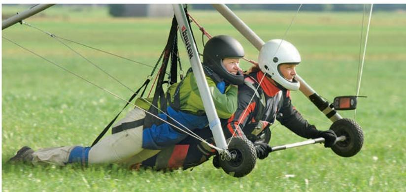
Bei der Radlandung fängt man später ab und gleitet tiefer aus als bei der stehenden, und man setzt sehr langsam auf. Die Daumen legt man besser auf die Basis; pendelt man doch durch, bleiben sie heil. Am Übungshang sind große Räder einfach unverzichtbar. Mit zu hoher Geschwindigkeit eingebombt, ist sonst ein Überschlag vorprogrammiert.
