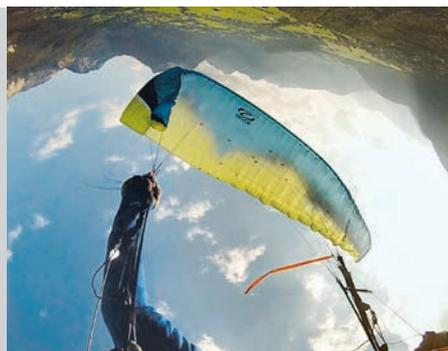
**Ozone Rush4:** Die Öffnung erfolgte meist rasch von der Mitte beginnend. Die noch eingeklappten Stabilos bremsen das Vornicken. Öffnete der Schirm zügig über die gesamte Spannweite, kam es durch das Vornicken zu erneuten Einklappen mit steiler Knicklinie, welche Verhänger verursachten (Bild rechts).
