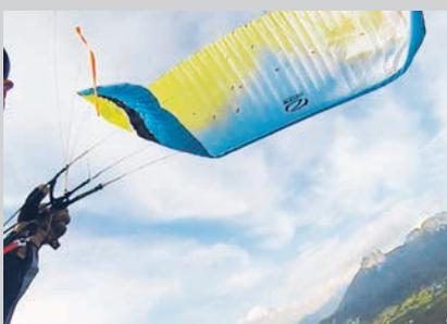
Ozone Rush4: Es war sehr schwierig, die Deformationen an den großen Rand des Messfeldes zu bringen (Bild links). Beim Öffnungsverhalten zeigte sich der Rush4 indifferent. Mal öffnete er sehr angenehm, Zelle für Zelle – mal schnalzte die eingeklappte Fläche schlagartig auf. Dabei kam es im unbeschleunigten Zustand zu kleineren Gegenklappen, welche eher dynamikmindernd wirkten (Bild rechts).
