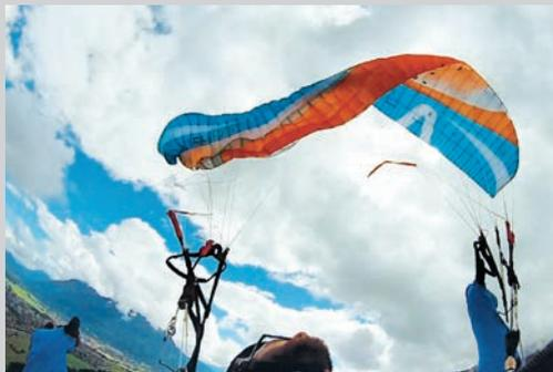
**Skywalk Tequila4:** Um die seitlichen Einklapper an den großen Rand des Messfeldes zu bringen (Bild rechts), mussten die Testpiloten sogar mit zwei Händen am A-Gurt ziehen. Eine ähnliche Klappresistenz zeigte auch schon der **Mescal4** - der A-Schirm von **Skywalk**.
