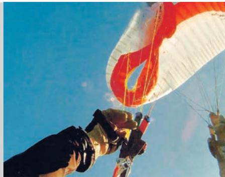
**Icaro Instinct TE:** Beim Instinct TE waren unbeschleunigt und beschleunigt sehr flächentiefe Deformationen möglich. Eine Simulation kleinerer Frontklapper erwies sich als schwierig. Frontrosetten nach vorne waren die Regel – verzögerten aber lediglich die Öffnungsdauer und erhöhten den Höhenverlust.
