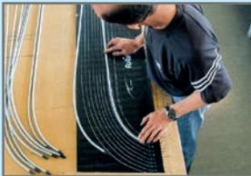
Prüfung der Segellatten anhand des Segellattenplans.
