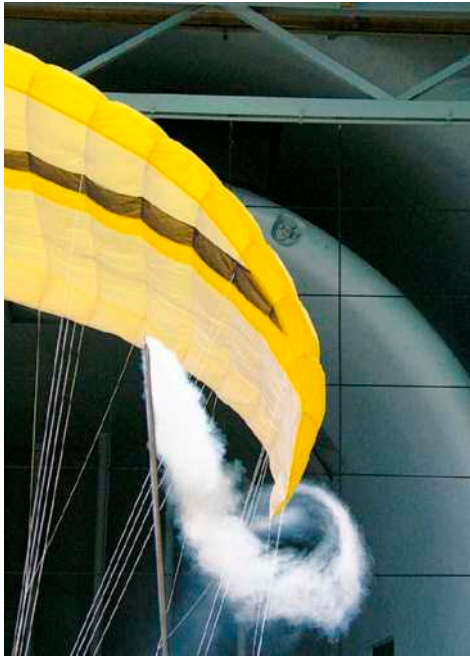
Bild 1 | Dieser im Windkanal sichtbar gemachte Wirbel entsteht hinter jedem Flügel, der sich bewegt. Je größer das Fluggerät, desto größer der Wirbel und umso länger steht dieser in der Luft. Hinter großen Flugzeugen können solche Wirbel einige Minuten stehen und dann immer noch so stark sein, dass sie Gleitschirme zum Klappen bringen. (Bild mit freundlicher Genehmigung von Manfred Kistler, Skywalk)
