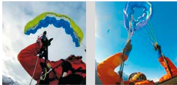
Swing Discus: Auch der Swing A-Schirm benötigt manchmal einige Sekunden, bevor der Frontklapper selbständig öffnet (rechts). Meist erfolgt die Öffnung aber schnell, gelegentlich bleiben die Ohren länger eingeklappt und öffnen zögerlich.
