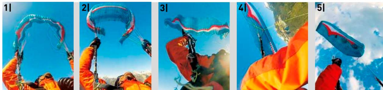
Gin Carrera S: Frontklapper mittlerer Größe (1) öffnen meist mit stark eingeklappten Flügelenden aber sonst selbständig (2). Sehr große Frontklapper (3) können extreme Dynamik generieren, z.B. so starkes Vorschießen, dass der Testpilot extrem stark anbremsen muss (4). Häufig auch ein- oder beidseitige Verhänger der Außenflügel, was einen sofortigen Piloteneingriff erfordert (5).
