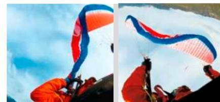
Gradient Bright 5 M: Extrem große und flächentiefe Klapper können auch beim diesem Schirm ein deutliches Vorschießen mit Gegenklapper ohne Richtungsänderung bewirken.
