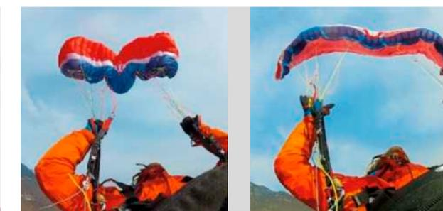
Gradient Bright 5: Kleine und sehr große Frontklapper (links) öffnen im Regelfall schnell oder nur leicht verzögert. Frontklapper mittlerer Größe (rechts) können für ein paar Sekunden stabil bleiben und einen größeren Höhenverlust verursachen (rechts). Gut zu sehen, wie sich durch die Anströmung von unten das eingeklappte Segel vor die Eintrittskante legt und dadurch die Öffnung verzögert.
