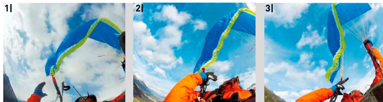
Nova Ion 3 M: Anhand dieser drei verschiedenen Einklapper ist die Bedeutung der Knicklinie gut zu erläutern: Je steiler diese ist (auf den Bildern von links nach rechts steiler werdend), desto mehr von der Flügelhinterkante ist von dem Klapper betroffen. Bei Klappern mit moderater Knicklinie (1) bleibt das Verhalten des Ion 3 überschaubar. Klapper mit sehr steiler Knicklinie (3) erzeugen einen ordentlichen Schub mehr Dynamik mit deutlichem Vorschießen und Höhenverlusten bis gegen 50 m.
