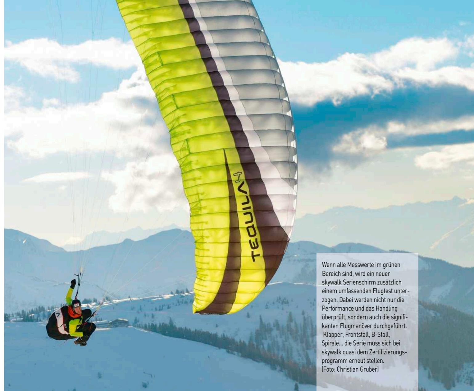
Wenn alle Messwerte im grünen Bereich sind, wird ein neuer skywalk Serienschirm zusätzlich einem umfassenden Flugtest unterzogen. Dabei werden nicht nur die Performance und das Handling überprüft, sondern auch die signifikanten Flugmanöver durchgeführt. Klapper, Frontstall, B-Stall, Spirale... die Serie muss sich bei skywalk quasi dem Zertifizierungsprogramm erneut stellen. (Foto: Christian Gruber)
