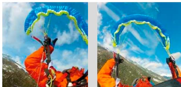
Nova Ion 3: Meist öffnen auch große Frontklapper nur verzögert mit länger eingeklappten Ohren. Manchmal war eine Tendenz zum kurzzeitig stabilen Frontklapper zu beobachten, der aber selbständig öffnete (rechts). Verhänger oder deutliche Tendenzen zur Frontrossette gab es nicht bei den Testflügen.
