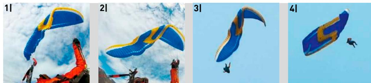
Sky Paragliders Atis 4: Unbeschleunigt war es für die Testpiloten schwierig, Klapper mit steilerer Knicklinie im Messfeld zu erzielen (1), die Reaktionen des Gerätes bleiben moderat. Beschleunigt klappt der Schirm allerdings sehr flächentief (2, 3), wegen der sehr schnellen Drehung muss sich der Testpilot aktiv gegen das Eintwisten wehren (4)
