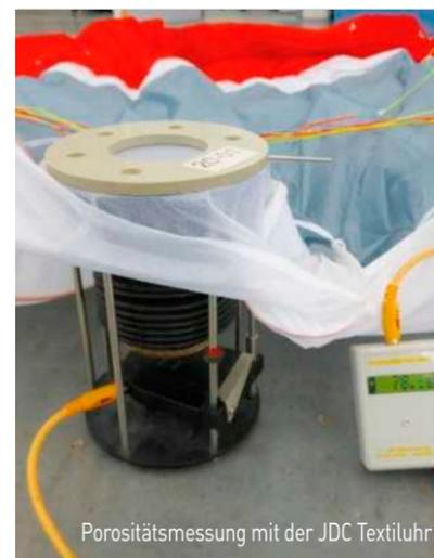
Porositätsmessung mit der JDC Textiluhr
