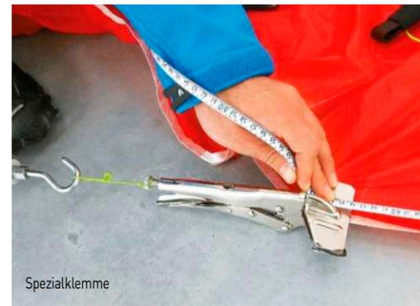
Diese Längen werden am Seriengerät mit einer kalibrierten Federzugwaage unter 5 daN Last überprüft. Um die Kraft am Segel schonend zu übertragen, wird eine spezielle Klemme mit geschützten Backen verwendet.
