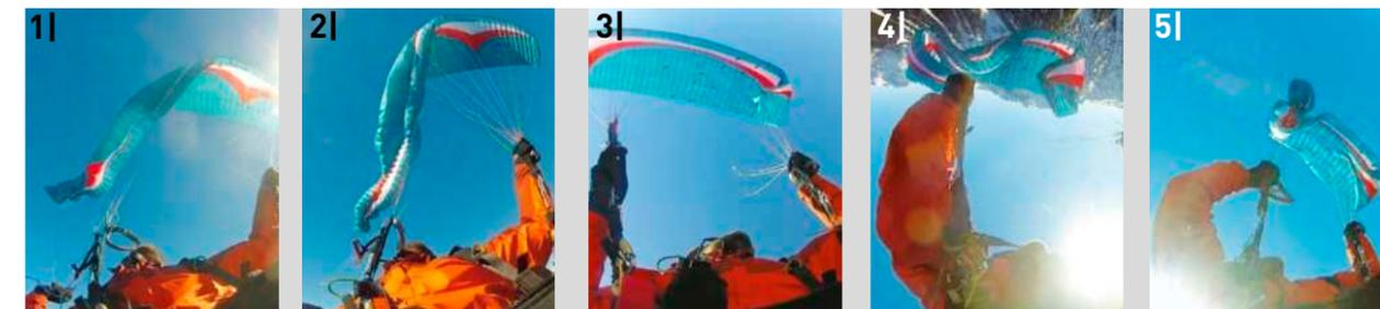
Gin Gliders Carrera S: Geräteaktion eher abhängig von der Einklapper-Knicklinie als von der Fluggeschwindigkeit. Bei mäßiger Knicklinie (1), weites Schießen, Gegenklapper mit kleinem Verhängen (3). Bei steilerer Knicklinie (2) sehr markantes Vorschießen, massives Gegenklappen und beidseitiges Verhängen (4, 5). Nicht jeder Klapper verhängte sich, es waren jedoch stets Verhängertendenzen zu erkennen.
