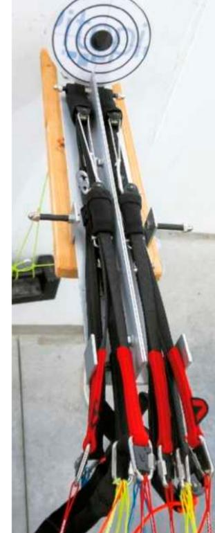
Einspannung der Tragegurte für die Laservermessung
