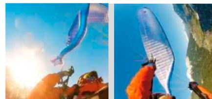
Swing Discus M: Große, flächentiefe Einklapper können ein deutliches Vorschießen mit Gegenklapper ohne Richtungsänderung generieren.
