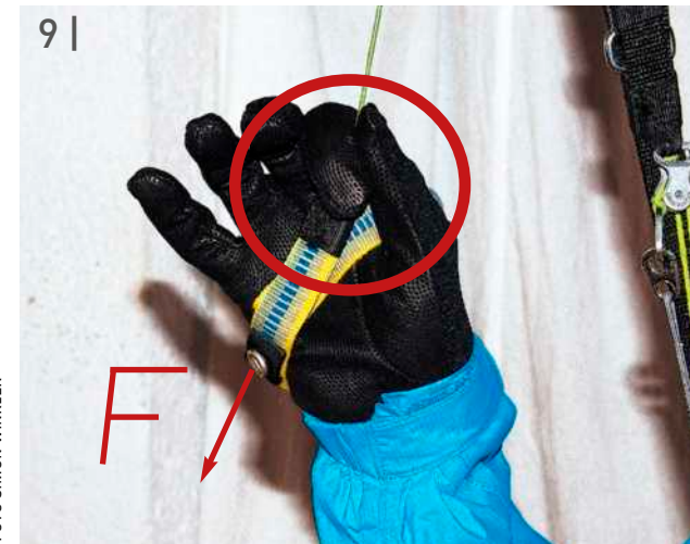
Optimale Steuerleinenhaltung: Greifen der Steuerleine am Knoten mit Daumen und Zeigefinger. Die Schlaufe wird weggeknickt. Kraftfluss ist somit an der Handkante (Pfeil), das Gefühl ist bei Daumen und Zeigefinger (Kreis).
