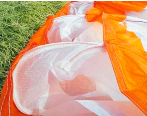
Ein typisches Konstruktionsmerkmal der gestuften Profile sind zwei sich kreuzende Stäbchen mit unterschiedlichen Biegeradien – hier am Beispiel des Gin Atlas. Foto: Lucian Haas
