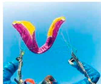
Ab einer Flächentiefe von ca. 60% bleibt der Frontklapper häufig stabil und zeigt dabei entweder eine Frontrossette (links) oder ein Umschlagen der Flügel nach vorne. In beiden Fällen musste der Testpilot aktiv eingreifen, um eine Öffnung zu erreichen.
