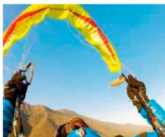
Gin Gliders Atlas: Kleine Frontklapper (links) waren problemlos. Weil der Schirm im Test aber in der Flügelmitte immer stärker einklappte als am Außenflügel (rechts)....
