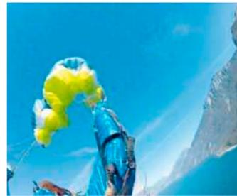
Ozone Buzz Z 4: Bei sehr tiefflächigen Frontklappern kippt der Schirm weit ab, öffnet aber schnell und meist symmetrisch.
