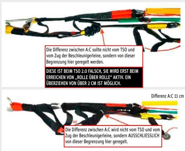
Alle Halter von Gleitschirmen der Muster Icaro Cyber TE werden aufgefordert, die Tragegurte zu kontrollieren. Sind am Gerät die betroffenen Tragegurte montiert, ist der Hersteller vor dem nächsten Flug wegen eines Austausches bzw. einer Änderung zu kontaktieren.
