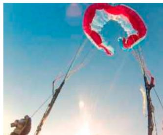
Gradient Golden 4: Besonders Frontklapper mittlerer Größe bleiben öfter stabil und müssen dann aktiv ausgeleitet werden.
