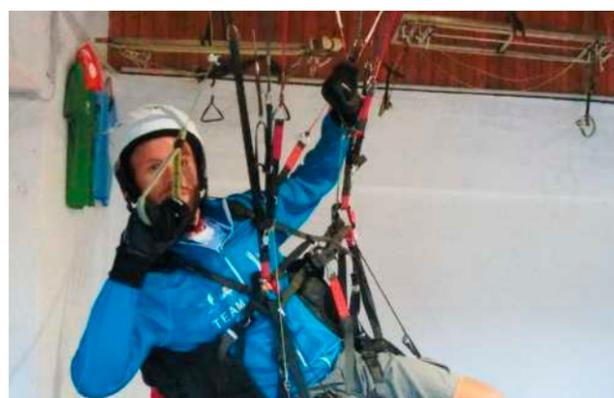
**10 |** Steuerung durch Gewichtsverlagerung und Steuerleine
