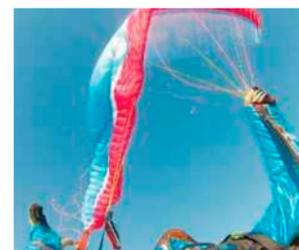
Gradient Golden 4: Hat eine eher weiches Klappverhalten, lässt dem Piloten etwas mehr Zeit, bevor er die Drehung beginnt. Dann geht die Kappe aber sehr deutlich auf die Nase und dreht auch nach dem Öffnen meist noch etwas nach.
