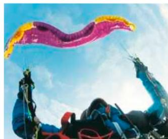
Niviuk Hook 3: Frontklapper bis ca. 50% öffnen problemlos und schnell (links), etwas größere Deformationen stark verzögert (rechts)
