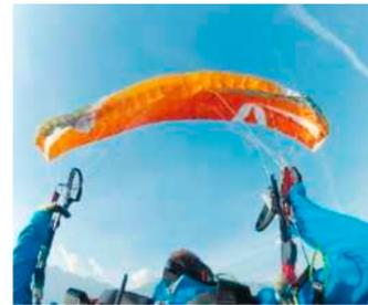
Skywalk Mescal 4: Bei der maximal erzielbaren Einklapptiefe von ca. 60% zeigte der Schirm ein weitgehend gutmütiges Verhalten mit schneller Öffnung.
