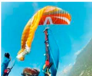
Skywalk Mescal 4 M: Auch sehr große und flächentiefe Klapper öffnen meist schnell und mit relativ geringem Wegdrehen/Vorschießen. In Einzelfällen aber auch längeres Wegdrehen bis 180° und größerer Höhenverlust.
