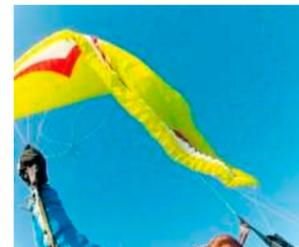
Gin Gliders Atlas: Insgesamt relativ wenig dynamisches Klappverhalten für einen B-Schirm. Die eingeklappte Fläche öffnet aber zögerlich, der Schirm bleibt dadurch länger in der Drehung.
