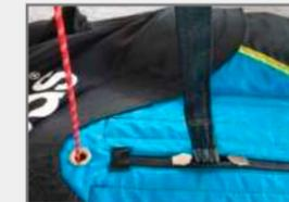
Die Hauptaufhängung muss auf Scheuerstellen untersucht werden.
