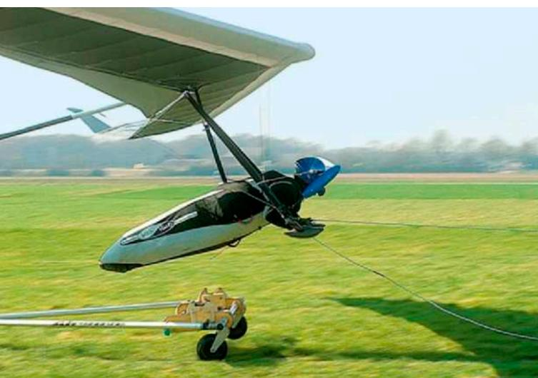
Der Startwagen hilft auch beim Windenstart und kann bei Seitenwind den Start mit dem Starrflügler sicherer machen
