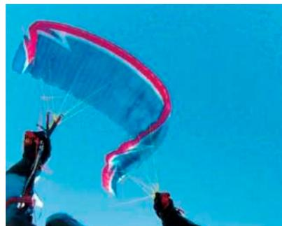
Tieflächige Einklapper (Bild oben links) können beim Mentor 3, besonders wenn diese dynamisch wieder öffnen (Bild oben rechts), zu weitem Vorschießen mit Gegenklapper (Bild links), jedoch ohne Verhänger (Bild rechts), führen.
