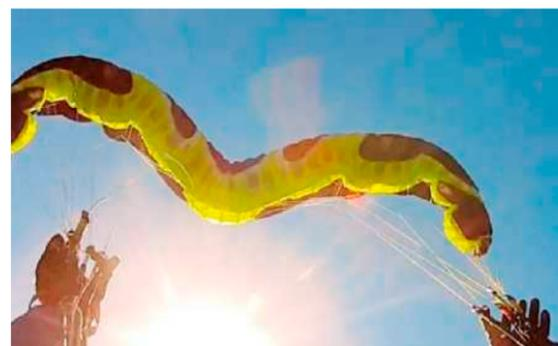
Kleinere Frontklapper öffnen beim Blacklight sehr zögerlich mit einer längeren Phase eingeklappter Flügelenden (Bild links). Große Frontklapper bleiben stabil und können schnell unkontrollierbar werden (Bild rechts). Die aktive Ausleitung über die Bremsen sollte rasch erfolgen, bevor die Schirmkappe verhängt oder in eine Rotation gerät.
