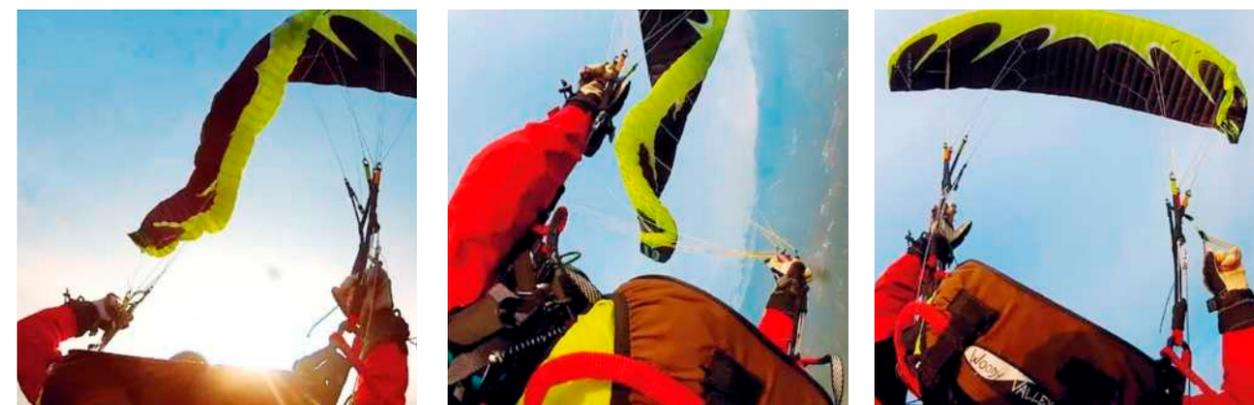
Der Blacklight klappt tief in die Fläche (Bild links) und kann, bei Klappen an der Grenze des Messfeldes, sehr dynamisch werden, mit Gegenklappen (Bild mitte) und leichten Verhängern (Bild rechts).
