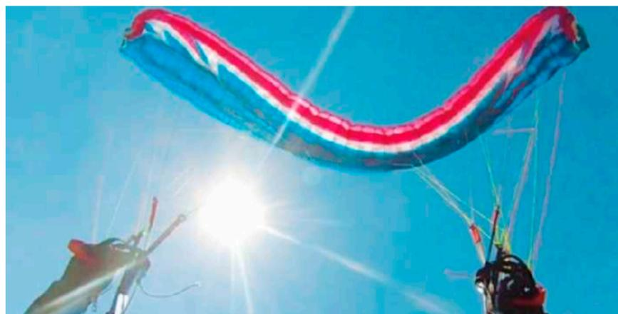
Spart sich die kurze stabile Sinkphase und biegt direkt nach der Einleitung in der Flügelmitte ab: Nova Mentor 3.
