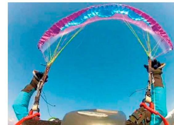
Bei kleineren Frontklappern kann der Epsilon 7 recht zügig, aber auch deutlich verzögert öffnen (Bild links). Bei großen Frontklappern bleibt auch beim Advance Intermediate die Kappe stabil in der Deformation und muss aktiv über die Bremsen geöffnet werden (Bild rechts). Im Gegensatz zum Blacklight ist die Drehbewegung im stabilen Frontstall nicht sehr stark ausgeprägt.
