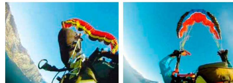
Knickt bei harten Frontklappern etwas in der Mitte ein und öffnet deshalb nicht immer symmetrisch: Independence Pioneer (links). Eine etwas schwächer ausgeprägte Tendenz zum asymmetrischen Öffnen war beim Icaro Cyber TE zu beobachten (rechts).
