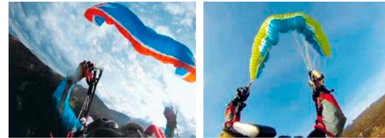
Der Nova SuSi im A-Segment (links) und der Low-Level-B Swing Arcus 7 (rechts) steckten massive Frontklapper mit dem geringsten Höhenverlust in der Testreihe weg.
