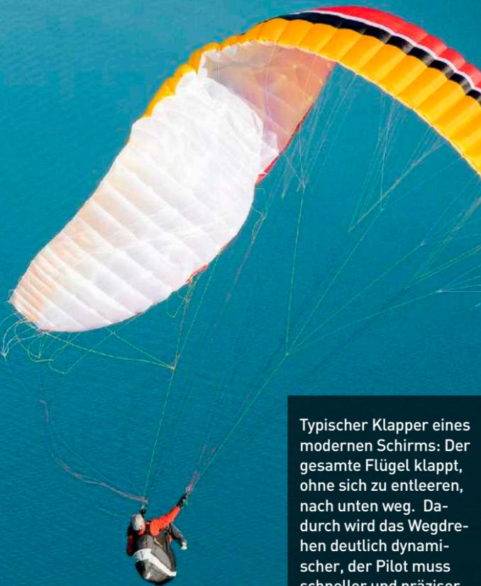
Typischer Klapper eines modernen Schirms: Der gesamte Flügel klappt, ohne sich zu entleeren, nach unten weg. Dadurch wird das Wegdrehen deutlich dynamischer, der Pilot muss schneller und präziser reagieren.
