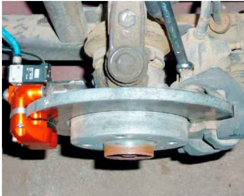
Neben der hydraulischen Betriebsbremse (rechts) wurde eine zusätzliche pneumatisch betriebene Bremszange (links) für die automatische Seilbremse montiert.
