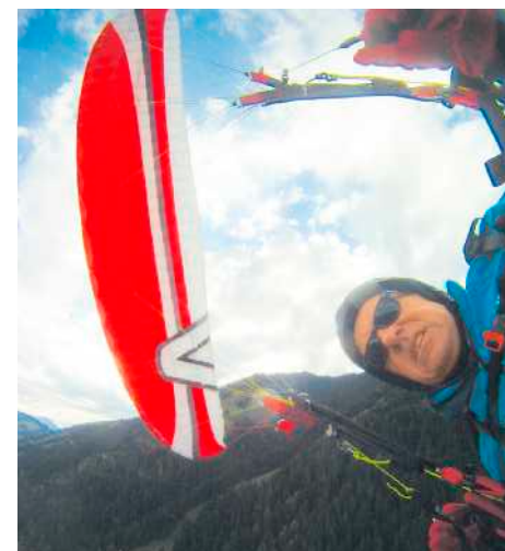
Ausleitung: Stärkeres Anbremsen der Kurvenaußenseite, bis die Kappe beginnt sich aufzurichten....
