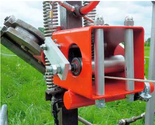
Umbau einer Bestandswinde: Eine „Messrolle“ auf dem Schleppseil steuert die pneumatisch betriebene zusätzliche Bremszange und verhindert sicher den gefährdeten „Seilsalat“.
