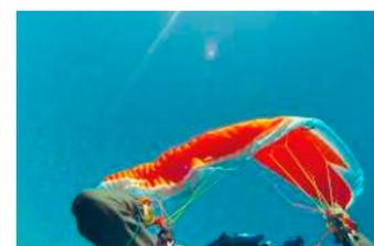
Auch an der Grenze des markierten Einklapper-Messfeldes reagiert der Nova Ion 2 im Rahmen des für die LTF-Klasse B Erlaubten.
