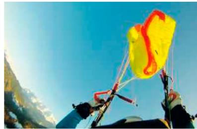
Flächentiefe Frontklapper führen oft zum Abknicken in Flügelmitte und zum Zusammenschieben der Fläche...
