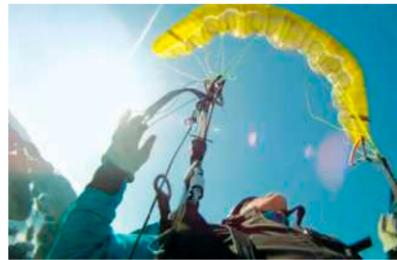
Der Alpha 5 reagiert auf harte Frontklapper mit einer raschen Wiederöffnung der Flügelmitte....
