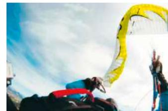
...und Emotion 2 klappten im Test sehr weit über die Flächentiefe mit steiler Knicklinie ein. Der hohe Widerstand dieser Einklappform generiert ein dynamischeres Verhalten als...
