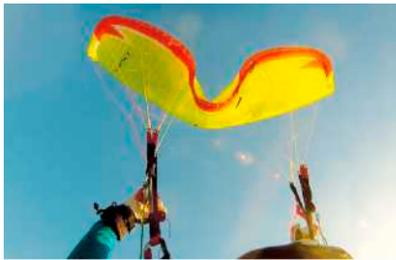
Kleinere Frontklapper öffnen beim Nova Ion 2 schnell und mit wenig Höhenverlust, zeigen aber bereits Deformationstendenzen.
