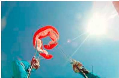
Der Gin Gliders Sprint Evo hat bei flächentiefen Frontklappern dagegen eine Tendenz, mit nach hinten geschlagenen Flügelenden stark verzögert, teilweise nur mit Piloteneingriff zu öffnen.
