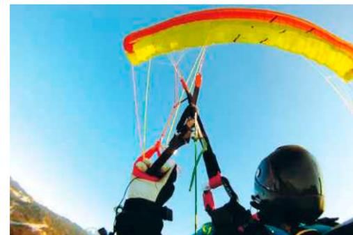
Bei längeren B-Stalls kann der Nova Ion 2 nach hinten deformieren.
