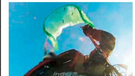
Jetzt Vorsicht mit den Bremsen! Mit eingeklappten Flügelenden und kurzzeitig im Sackflug (sichtbar an der nach oben gebogenen Mitte der Hinterkante) fährt der Ozone Mojo 3 nur zögerlich aus der Deformation des Frontklappers an.
