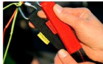
Vorbildlich: Kennzeichnung der Tragegurte für den B-Stall und das Ohrenanlegen beim Nova Prion
