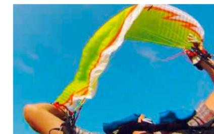
Dieser Klapper mit dem Mentor 2 liegt sauber im Messfeld. Der Schirm ist bis über die Hinterkante eingeklappt.
