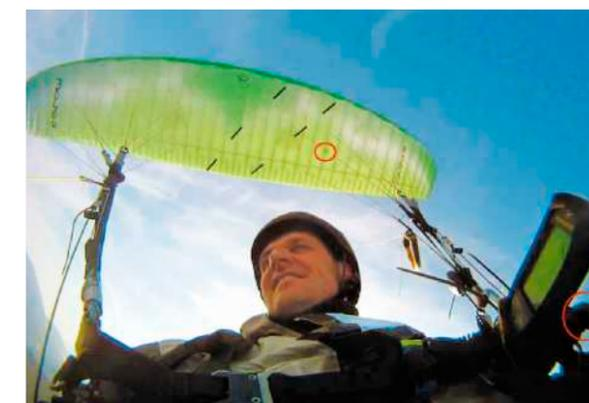
Die Datenlogger am Piloten und in der Kappe des Gleitschirms kommunizieren mittels Kurzstreckenfunksignalen
