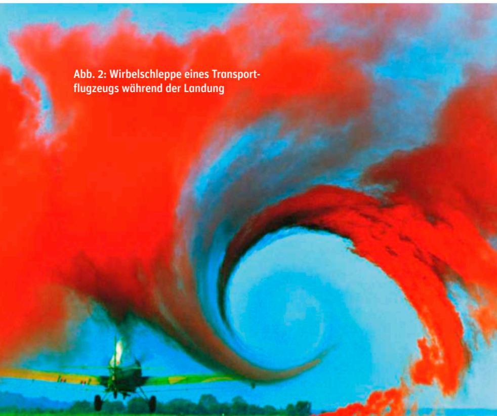
Abb. 2: Wirbelschlepe eines Transportflugzeugs während der Landung
