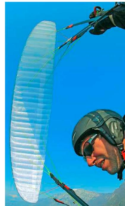
Echte Zweileiner wären auch mit wenig gestreckten Schirmen möglich. Hier ein EN-B Zweileiner-Proto, der zwar fliegt und sicher ist, aber keinerlei Abstieghilfen ermöglicht!
