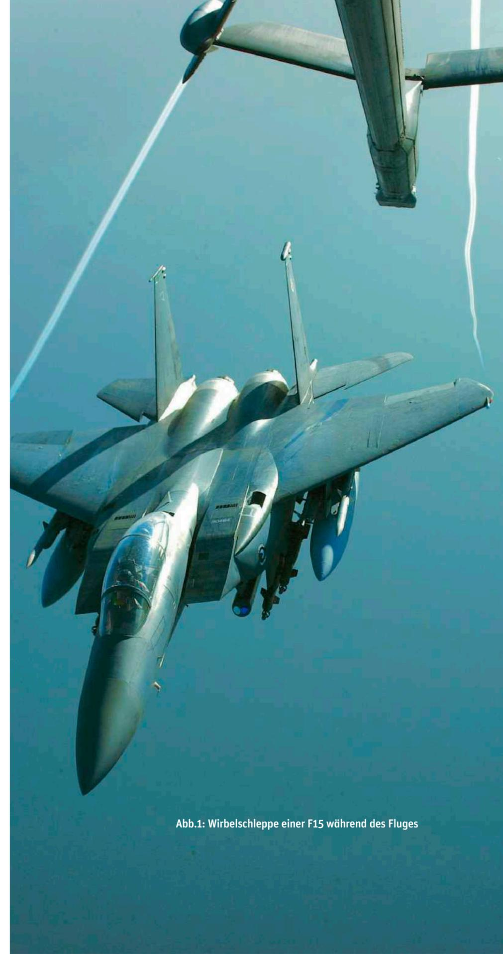
Abb.1: Wirbelschlepe einer F15 während des Fluges
