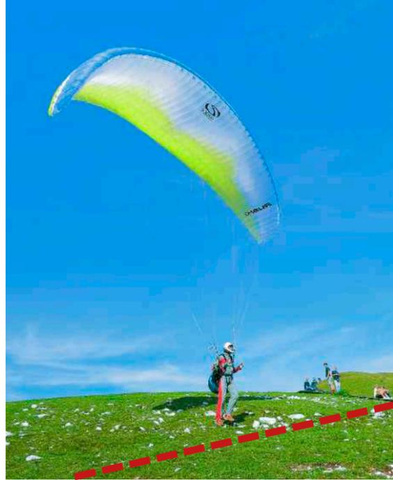
Der Pilot ist an seiner Entscheidungslinie und hat seine Kontrolle noch nicht abgeschlossen. Er darf sich daher nicht für einen Start entscheiden und leitet einen Abbruch ein.
