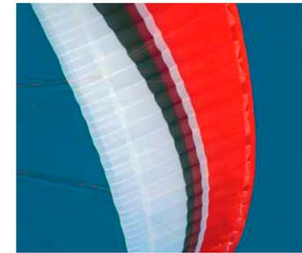
Miniribs und Spannbänder nahe der hinteren Leinenebene: Durch die zusätzliche Versteifung der Abström kante erhält man eine effizientere Bremswirkung, ähnlich der Klappen bei einem Flugzeug.
