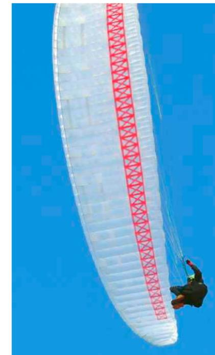
Der umgekehrte Weg: Vier Aufhängungspunkte (A,B,C,D) an der Kappe, sehr kurze, intelligent positionierte und sehr kurze Gallerieleinen und spezielle Spannbänder: Dennoch kaum mehr Leinenmeter als bei einem entsprechenden Zweileinerprojekt, dafür aber mehr Sicherheit und ein problemloses Startverhalten.
