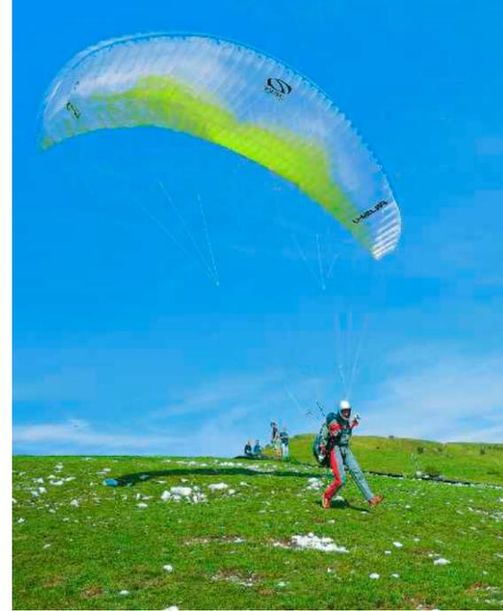
Die rechte Steuerleine wird energisch gezogen, um den Schirm nach rechts zu drehen. Die Bewegungsrichtung des Piloten bleibt noch für einen Moment geradeaus, damit sich die Kappe nach rechts neigt.
