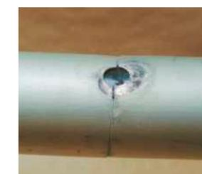
Bruchstelle an der Bohrung
