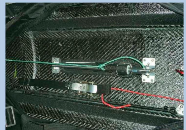
Rückenplatte aus Carbon mit Kickass-System
