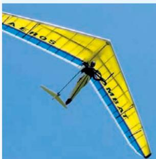
Der Hängegleiter Combat 13.5 09 GT des Herstellers AEROS Ltd. hat die Musterprüfung des DHV mit der Klassifizierung 3 nach den Lufttüchtigkeitsforderungen für HG und GS erfolgreich abgeschlossen. Produktinformationen des Herstellers unter [www.aeros.com.ua](http://www.aeros.com.ua)
