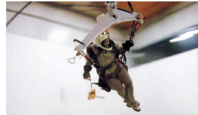
Wir montierten einen Beinstrecker an ein Gurtzeug mit Bottomcontainer. Bei den zwei durchgeführten Versuchen war das Ergebnis eindeutig: Der Beinstrecker wurde vor die Containeröffnung geweht, der Retter fiel bei der Auslösung durch den Beinstrecker. Dem Piloten wäre es nicht mehr möglich gewesen, den Rettungsschirm wegzuschleudern.
