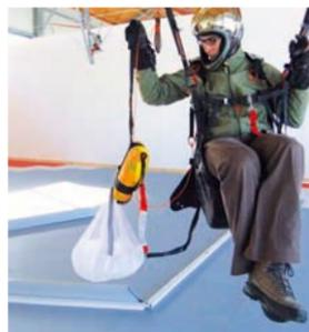
Ergonomisch nicht optimal: lange Verbindung zum Innencontainer
