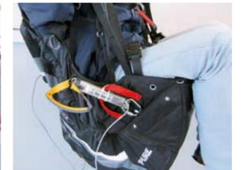
Messgerät mit Datenlogger zur Messung der Auslösekraft
