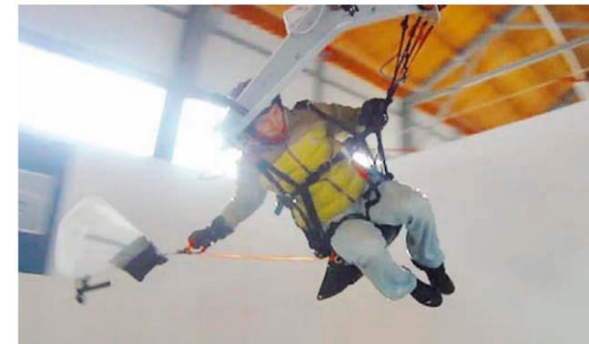
Das Skyline Pure sorgte zunächst bei der Identifizierung für Verwirrung. Im Gurtzeug befand sich eine Musterprüfplakette mit DHV-Gütesiegelnummer. Es zeigte sich jedoch, dass diese Nummer beim DHV einem 2006 geprüften Vorgängermodell zugeordnet war, mit anderem Rettungsgerätecontainer. Die Recherche ergab, dass das aktuelle Pure, so wie wir es beim Auslösetest hatten, bei der EAPR mustergeprüft worden ist.
