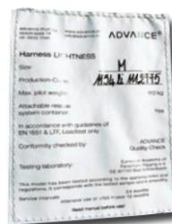
Diese Tatsache geht aus der Kennzeichnung (Plakette) des Gurtzeugs jedoch keineswegs deutlich hervor. Dort ist vermerkt „in accordance to guidelines of EN 1651/LTF, loadtest only“. Und zudem: „This model has been tested to the applying rules and regulation ..... and is air-worthy“.
