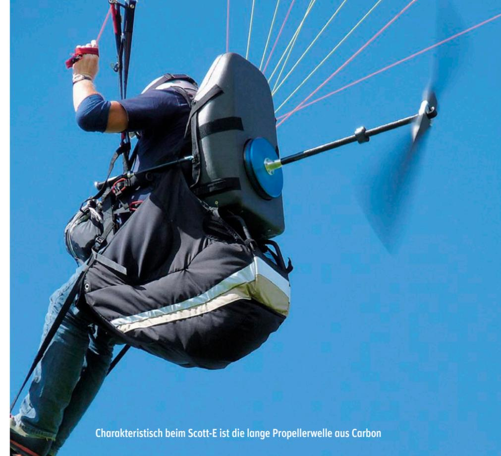
Charakteristisch beim Scott-E ist die lange Propellerwelle aus Carbon
