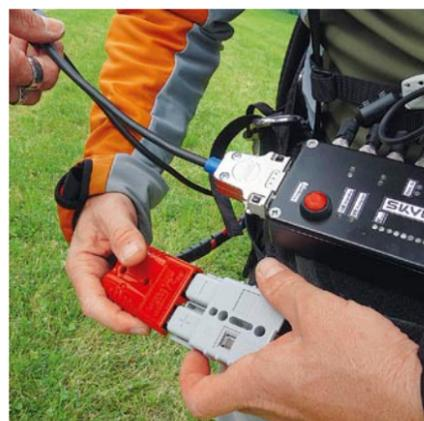
Verbindung der Antriebseinheit mit dem Akku
