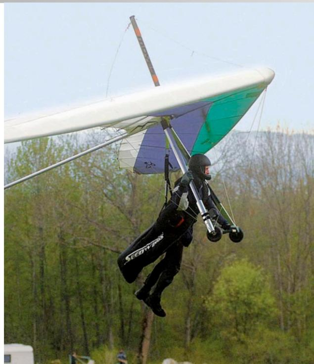
Ein modernes Intermediate-Gurtzeug ermöglicht eine schöne aufrechte Position – eine gute Ausgangslage für eine saubere gestandene Landung.
