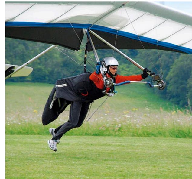
Bei Gurtzeugen mit Seilklemme braucht es einen Impuls zum Aufrichten. Hier liegt der Pilot zu waagrecht; die Arme werden zu kurz zum Rausdrücken. Tipp: Aufrichten im Flug üben.
