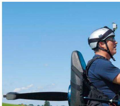
Bei stehender Welle klappt der Faltpropeller nach vorne
