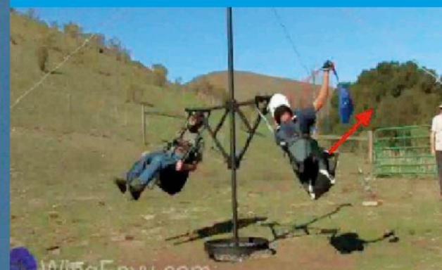
Linksspirale, Retterauslösung rechts. Wegen der Schräglage des Piloten hat die Richtung der Retterauslösung zwei Komponenten; nach außen und nach oben. Foto: [www.wingenvy.com](http://www.wingenvy.com)
