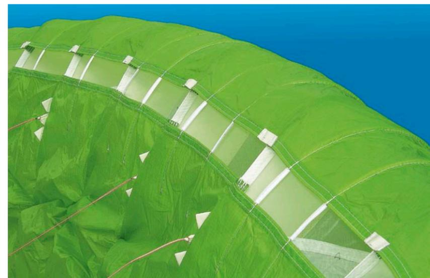
Links: Hier sind die Rigidfoils und die experimentellen A-Anlenkpunkte gut sichtbar. Der vorderste Anlenkpunkt entspricht der konventionellen Position. Dieser Proto flog am besten mit der hintersten Position.
