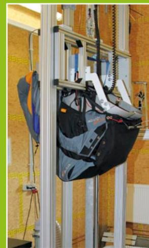
Testaufbau bei der Protektorprüfung
