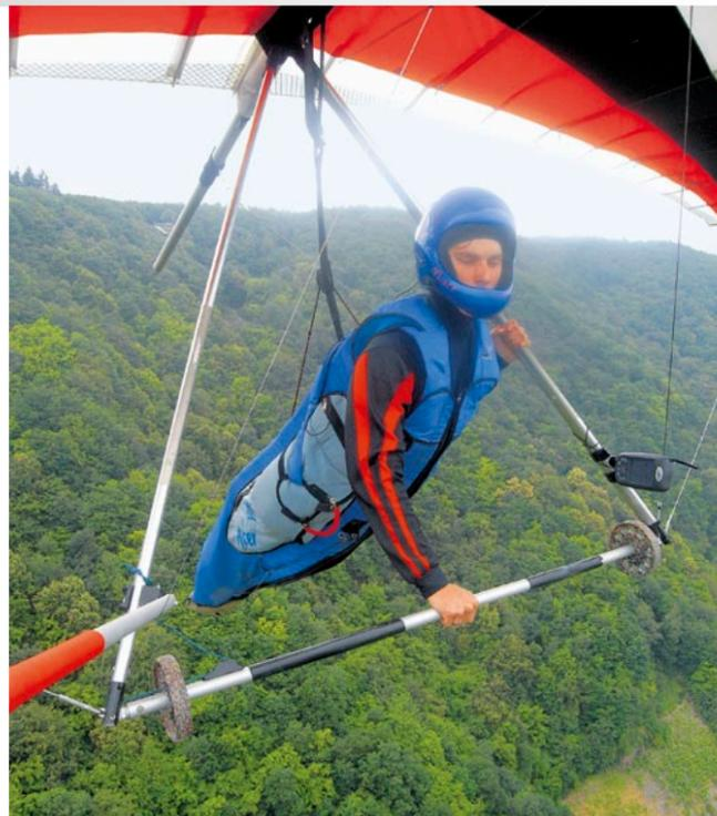
Bei einem Gurt wie diesem wird das „Neigungsseil“ durch eine Klemme geführt, die das Seil etwas bremst. Eine eingenommene Position wird dadurch leichter gehalten, zur Neigungsänderung gibt man einen Impuls.
