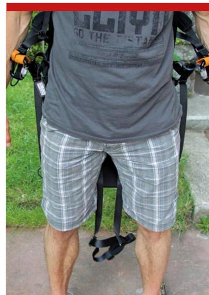
Abbildung 2: Bei solchen Gurtzeugen ist ein Start mit offenen Gurtzeug-Verschlüssen, wie im Bild, praktisch unmöglich.
