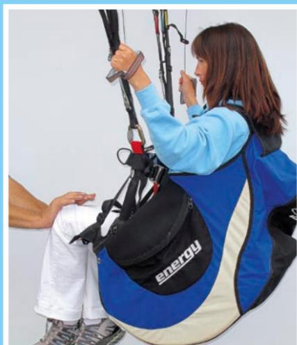
Durch nach Hinten Drücken mit etwa 20 kg wird die reelle Position im Flug simuliert
