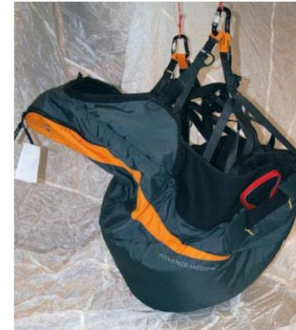
Abbildung 3: Gut zu erkennen: Bei leerem Staufach bietet das Axxess 2 Air keinen Schutz für den mittleren und oberen Rücken.
