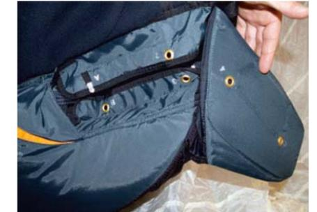
Abbildung 4: Die Reihenfolge, in der die Blätter des Außencontainers verschlossen werden müssen, sind markiert.
