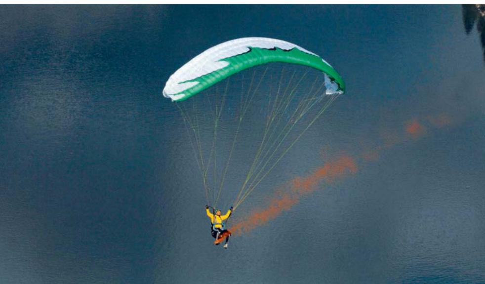
**Manöver 7:** Prüfung der Rollstabilität und Rolldämpfung
