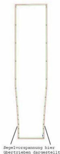
Segelvorspannung übertrieben gezeichnet, hier an der Hinterkante
