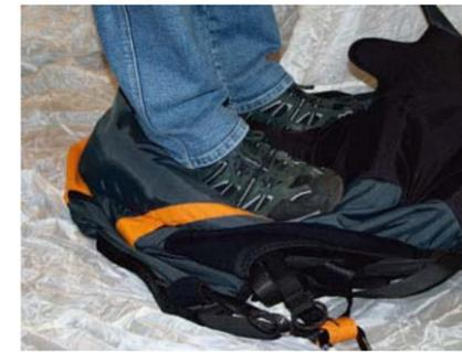
Abbildung 2: Hat unsere grobe Behandlung gut weggesteckt; Auch nach der Rosskur von 100 Mal Komprimieren in allen Varianten bläst sich der Protektor zuverlässig selbständig auf.
