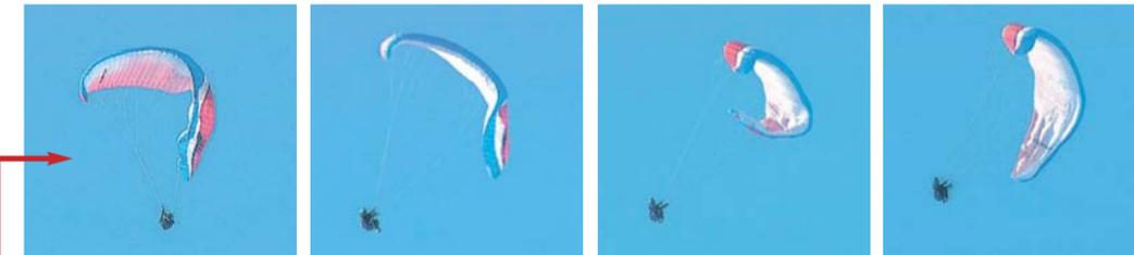
Nesler-Griff beim Ozone Rush mit unverkürzter Bremse: deutliches Wegdrehen, deutliches Vornicken
