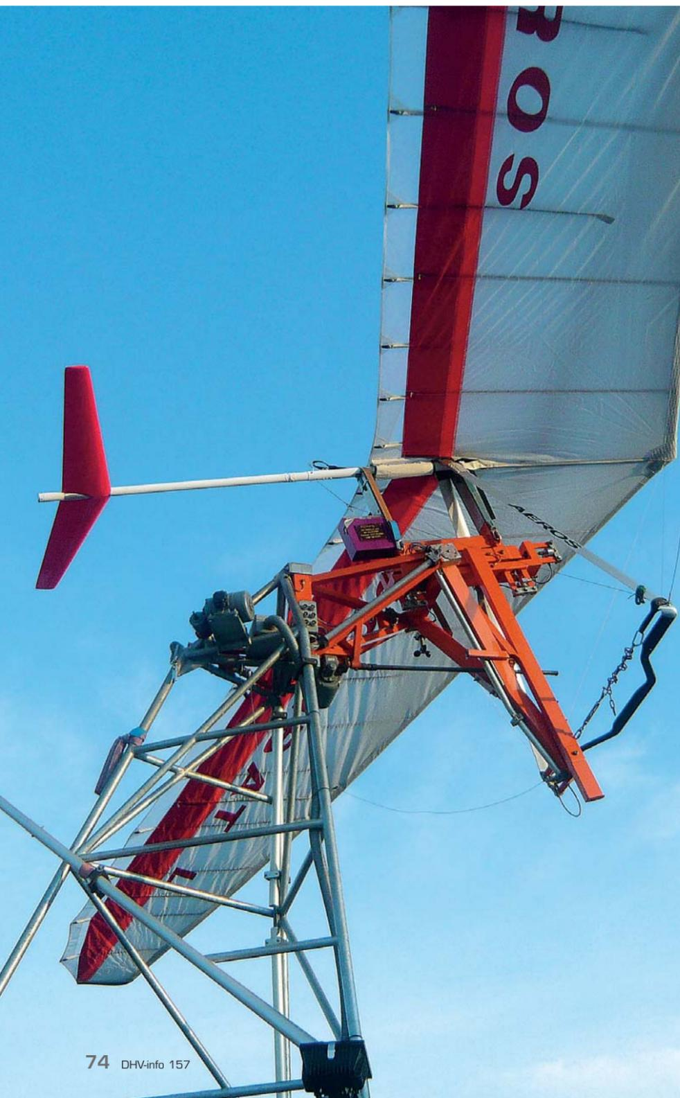
Spätestens seit den Überschlagsuntersuchungen des DHV 1997 ist bekannt, dass die Überschlagsgefahr bei Flugdrachen durch ein Leitwerk drastisch reduziert werden kann. Neben dem Aufrichtemoment des Flügels, das durch die Schränkungsanschlänge bewirkt wird, kann ein Leitwerk das Aufrichtemoment zusätzlich verbessern. In jedem Fall aber bringt es einen Dämpfungseffekt, der die Drehung bremst.
