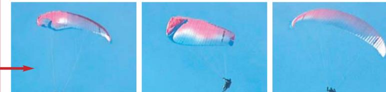
Nesler-Griff beim Ozone Rush mit einer „halben Wicklung“ der Steuerleinen. geringes Wegdrehen, geringes Vornicken
