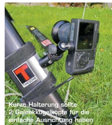
Kurze Halterung sollte 2 Gelenkkugelköpfe für die einfache Ausrichtung haben
