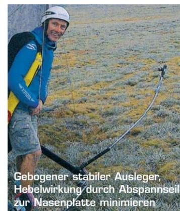
Gebogener stabiler Ausleger, Hebelwirkung durch Abspannseil zur Nasenplatte minimieren
