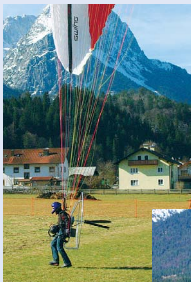
Start mit dem Elektro-Gleitschirm mit Klapp-Propeller
