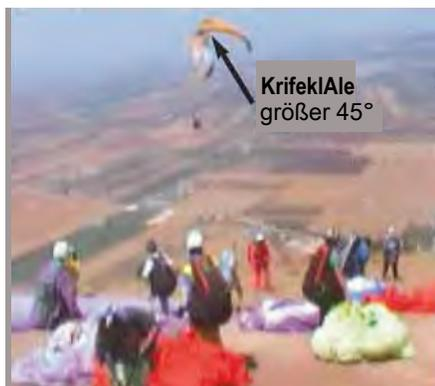
erkennbar, dass die Knicklinie, mit der die Kappe in die Flächentiefe deformiert, deutlich steiler ist als die 45°, mit der nach derzeitigen Lufttüchtigkeitsforderungen getestet wird.
