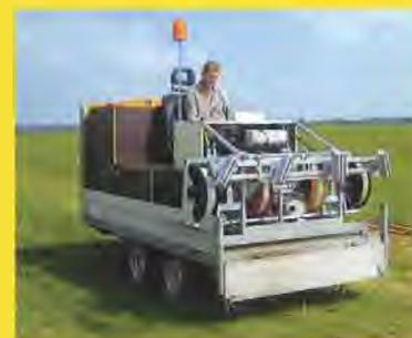
Martin Schaffer, Hersteller der ELWISA-Elektrowinde, führt seine innovative Entwicklung vor. Sie ist die erste zugelassene Elektro-Serienwinde auf dem Windenmarkt. Der Schleppbetrieb erfolgt mit Generator im Außengelände. Flachschleppvorführungen zur Demonstration der Regeltechnik sind einer der Programmpunkte.
