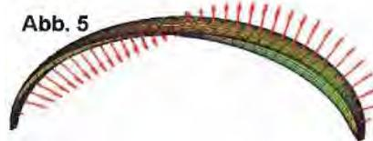
der Hinterkanten. Dabei produziert die lokale Verformung der Hinterkante zusätzliche Druckkräfte: erhöhten lokalen Auftrieb (wegen der lokalen starken Krümmung) und starken zusätzlichen lokalen Widerstand wegen der Stauwirkung unten vor der herabgezogenen, annähernd vertikal ausgeformten Hinterkante.
