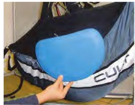
Bild 9: Position des Seitenprotectors im Inneren des Gurtzeugs
