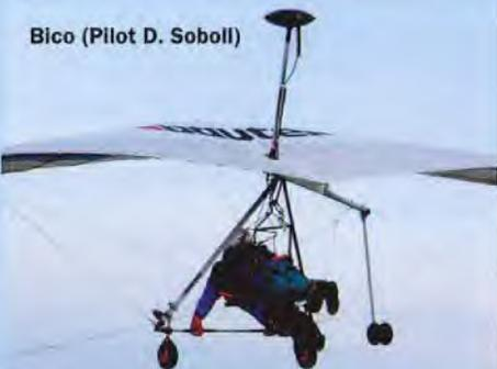
strukturer und Hersteller ist. Auf diesen Fahrwerken wurden zwischenzeitlich mehr als 3000 Starts und Landungen im doppelsitzigen Flugbetrieb nachgewiesen. Das Spornradfahrwerk wurde nach hinten zum Kielrohr und seitlich zu den Trapezecken verspannt. Dadurch werden die Torsionskräfte minimiert, die am Kielrohr auftreten. Als Gurtzeug wurde ein Etagengurt der Fa. Madreiter verwendet.
