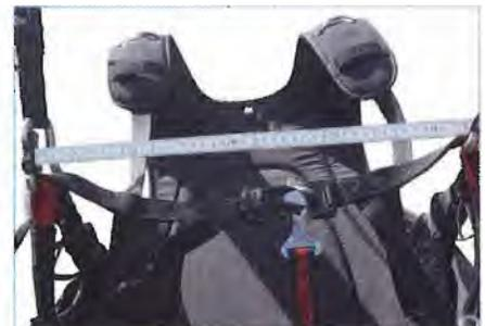
Brustgurteinstellung: Links maximal weit geschlossener Brustgurt (35cm), Mitte maximal weit offener Brustgurt (55 cm), rechts eine moderate Einstellung (43 cm), wie sie von vielen Herstellern empfohlen wird.
