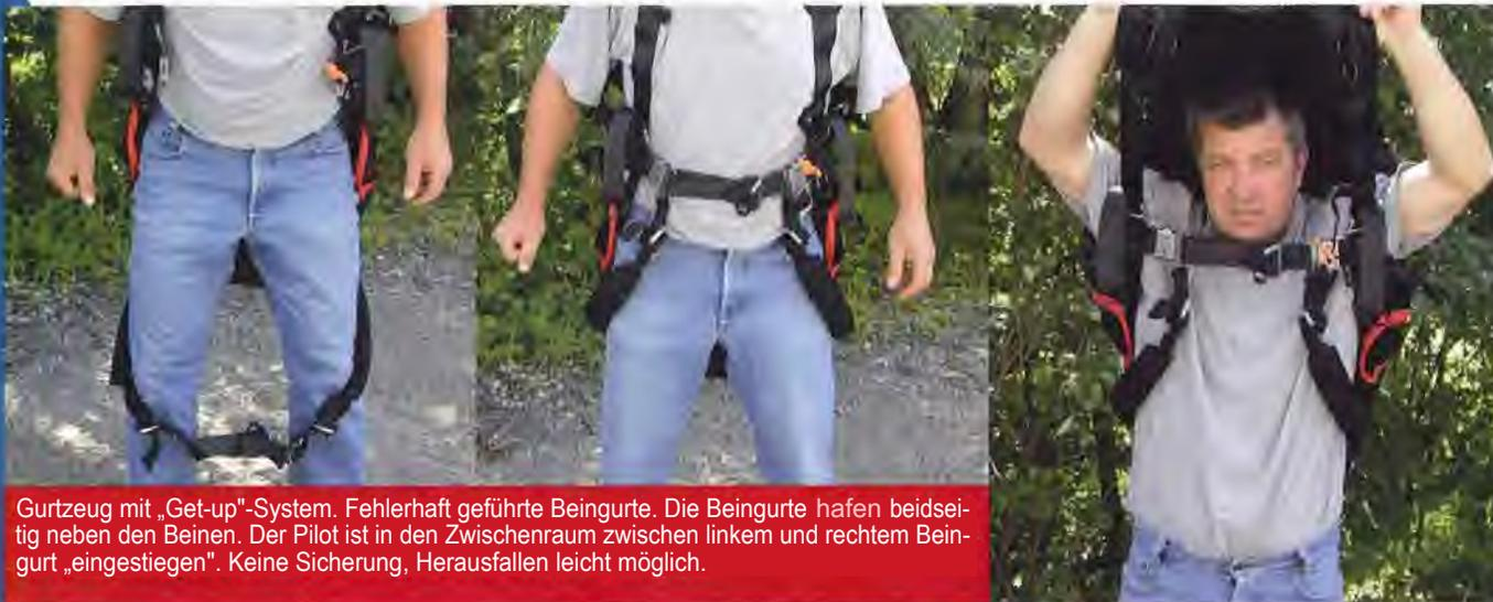
Gurtzeug mit „Get-up“-System. Fehlerhaft geführte Beingurte. Die Beingurte hafen beidseitig neben den Beinen. Der Pilot ist in den Zwischenraum zwischen linkem und rechtem Beingurt „eingestiegen“. Keine Sicherung, Herausfallen leicht möglich.
