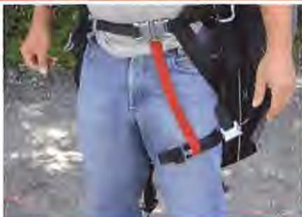
Konventionelles Gurtzeug mit separat verschließbaren Beingurten und Herausfallsicherung. Offene Beingurte und fehlerhaft geführte Herausfallsicherung. Herausfallen leicht möglich.
