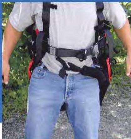
Gurtzeug mit „Get Up-System“. Fehlerhaft geführte Beingurte. Beide Gurte werden seitlich an einem Oberschenkel vorbei geführt und mit dem Brustgurt verbunden. Keine Sicherung, Herausfallen leicht möglich.
