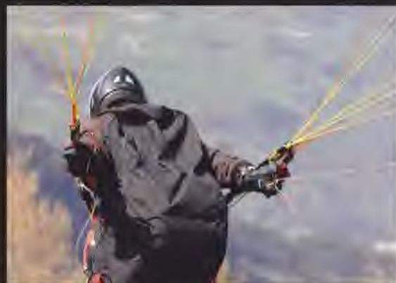
Mißachtung von Sicherheitsregeln: Schlampiger. Startcheck! Resultat ein verdrehter Tragegurt!
