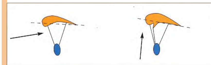
Abb.6: Schirm im Normalflug. Der Anstellwinkel ist definiert als der Winkel zwischen Profildrehse (gestrichelte Linie) und der Anströmrichtung (Pfeil). Beim Vornicken der Kappe wird der negative Anstellwinkel (zu kleiner Anstellwinkel = Einklapper) relativ bald erreicht.
