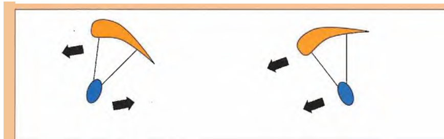
Abb.4: Werden im Fullstall die Bremsen gelöst, wenn der Schirm hinter dem Piloten ist, wird die Kappe nach vorne/unten beschleunigt und der Pilot nach hinten/oben. Das ist ideal für einen „optimalen“ Pendelausschlag des Systems Pilot-Kappe. Der Schirm wird maximal weit nach vorne schießen und zwar so lange, bis die Bewegung des Piloten nach oben gestoppt ist. Das kann im Extremfall erst sehr spät erfolgen und einen Sturz in die Kappe zur Folge haben.
