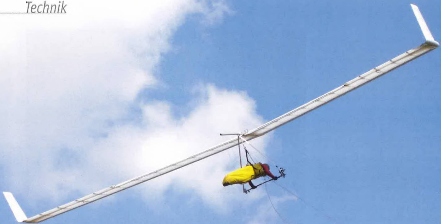
„Impact“, der Hängegleiter mit der höchsten Streckung, der je gebaut wurde
